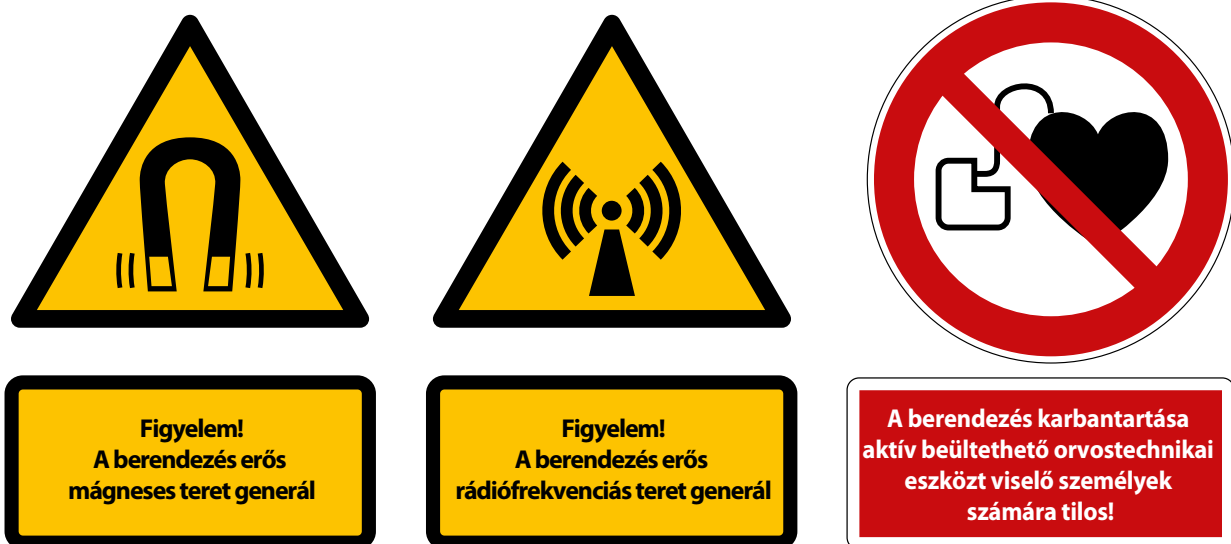
9.5. ábra: Példák az erős mágneses terekre és RF-terekre vonatkozó figyelmeztető jelzésekre, és az aktív beültethető orvostechikai eszközt viselő személyeknek szóló tiltó szimbólum illusztrációja
