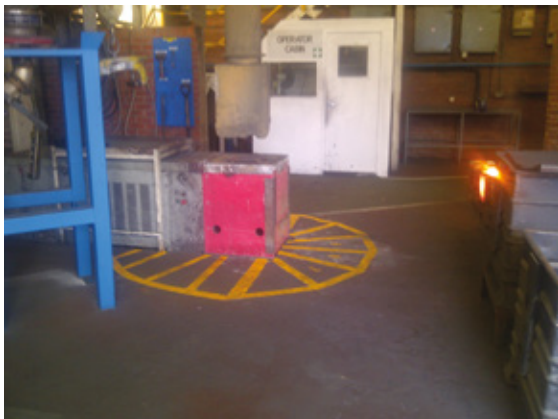
8.7. ábra: Padlóra festett jelek és kapcsolódó figyelmeztetések azon területek jelzésére, amelyeken belül túlléphetik a beavatkozási szinteket
