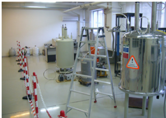
2.4. ábra: A korlátozott terület leválasztása lánckorláttal és a padló megjelölésével
