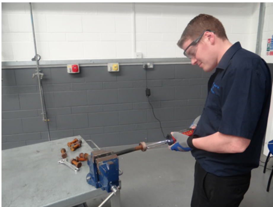
6.3. ábra: Beragadt csavar hevítésére használt 1 kW-os kézi indukciós hevítő
