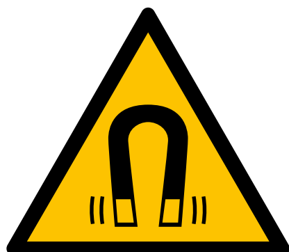
4.12. ábra: Példák az erős mágneses terekre figyelmeztető jelzésekre, és az aktív beültethető orvostechnikai eszközt viselő személyeknek szóló tiltó szimbólum illusztrációja
