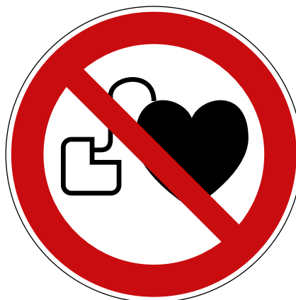
4.12. ábra: Példák az erős mágneses terekre figyelmeztető jelzésekre, és az aktív beültethető orvostechnikai eszközt viselő személyeknek szóló tiltó szimbólum illusztrációja
