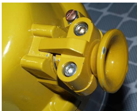
Rögzítő bilincs (tömítő gumi gyűrűtől függetlenül szorítva)
